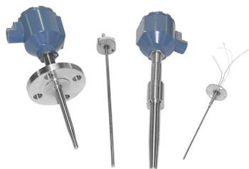
この小型バーストックサーモウェルは柔軟なソリューションとしてフランジ式または溶接式の取付方式で設計されており、テーパ型先端部によって応答時間を迅速化できます。さらに、サーモウェル材の幅広い選択肢によってプロセスの適合性を確保し、完全溶け込み溶接を標準にして強度を高めています。
