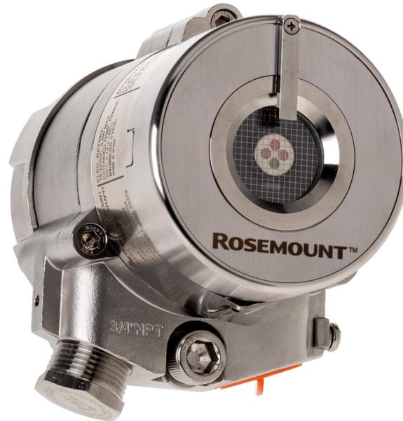
Rosemount 975HR マルチスペクトラム赤外線水素炎検知器は、炭化水素や水素の火炎を検知するために特別に設計されたものです。炭化水素を主成分とする燃料やガスの火災を長距離で検知し、誤報に対する高い耐性を備えています。Rosemount 975HR は、市場で最も耐久性と耐候性に優れた水素炎検知器です。結露や凍結を防ぐヒーター付きウィンドウ、HART® 通信プロトコル、低電力要件、コンパクトな軽量デザインなどが特長です。
