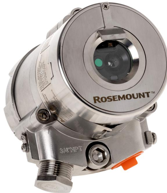
Rosemount 975UR 紫外線・赤外線（UV/IR）炎検知器は、電磁スペクトルの紫外線部分と赤外線部分の両方で、波長の短い部分の放射エネルギーを感知し、炭化水素系燃料とガスの火災を検知することができます。両方のセンサからの信号を分析し、周波数、強度、持続時間を割り出します。UV センサと IR センサ両方が同時に放射エネルギーを検知すると、警報信号がトリガーされます。UV センサに専用のロジック回路を搭載し、太陽放射による誤警報を防止しています。
