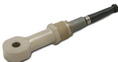
Rosemount 228 トロイダル導電率センサは、耐薬品性ガラス充填 PEEK または Tefzel™ で成形されており、酸、塩基、塩溶液の濃度測定に最適です。センサには、温度補正用の PT-100 抵抗温度デバイス (RTD) が内蔵されており、ケーブル長は 6.1 m (20 フィート) です。Rosemount 228 は、設置要件を満たすために、さまざまな挿入取り付けアダプタと組み合わせて使用できます ([アクセサリ](#)を参照)。
