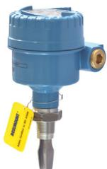
Rosemount 2120 レベルスイッチは、設置が簡単で、信頼できるレベル検出およびコントロールを提供します。サードパーティによる IEC61508 (SIL2) 安全および衛生認証と、任意の出力により、さまざまな用途に適しています。可動部がなく、校正が不要なので、実質的に処理の状態による影響を受けません。切り替え遅延を調整可能とすることにより、乱流用途による誤切り替えを防止します。
