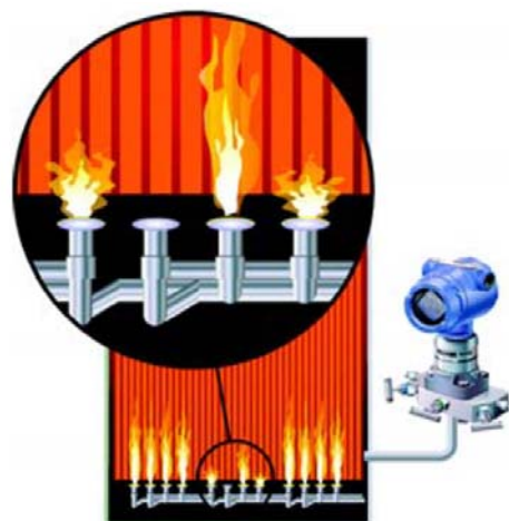
使用罗斯蒙特 3051S 检测熔炉火焰的不稳定性
