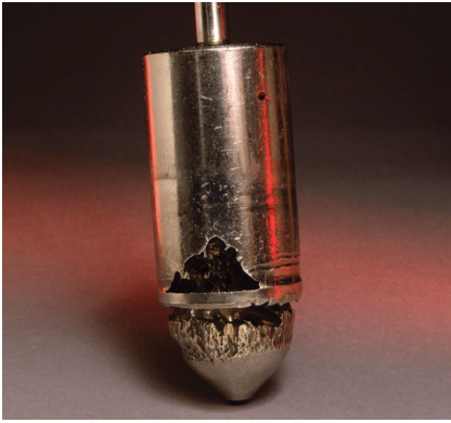
图 5.8 闪蒸破坏的典型外形
