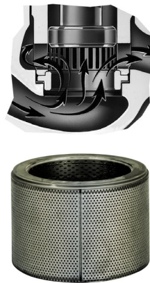
图 5.10 降低流体动力噪音的阀内件设计
