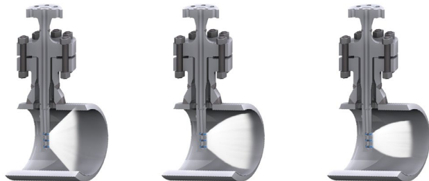
图 7.3 减温器喷水穿透度
