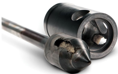
图 5.9 气蚀破坏的典型外形
