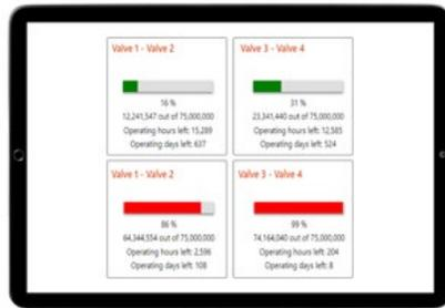
艾默生的软件解决方案可提供蒸汽阀生命周期监控，具有分析功能，设计用于在故障发生前进行预测。这支持预测维护策略，在阀门需要更换时提醒进行维护，以防止表现不佳的硫化造成昂贵的后期轮胎报废和生产损失。
