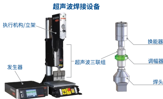
图1: 超声波焊接系统的部件
