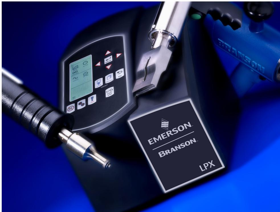
LPX パワーサプライは一定振幅の超音波振動エネルギーを発生する装置です。被加工物に加圧された状態でホーン先端面の負荷が増大すると、パワーサプライは出力を上げて設定振幅を維持するように制御します。従ってホーンが空気中（無負荷）で振動している状態では最小出力で振幅を維持します。
