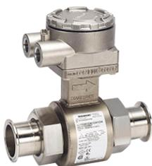
8721 卫生型传感器专为食品、饮料和生命科学的应用而设计。强大的全焊式大口径流量传感器由经 FDA 认证的材料制成，授权有 3-A 标志（授权编号 1222），。其口径范围为 ½ 英寸（15 毫米）至 4 英寸（100 毫米），适用于多种工业标准的工艺连接件。
