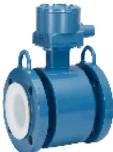
所有法兰型传感器均由不锈钢和碳钢制成，并进行了焊接，实现了全封闭，使传感器可以抗湿，并避免其他污染。其口径范围为 ½ in.(15 mm) 至 36 in.(900 mm)。密封外壳可以防止所有内部部件和接线遭受最恶劣环境的影响，从而最大限度地确保传感器的可靠性。
