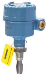
Rosemount 2120 液位开关易于安装，可提供可靠的液位检测和控制。已通过第三方 IEC61508 (SIL2) 安全和卫生认证，并提供输出选项，因而适合广泛应用。没有可移动部件，不需要标定，几乎不受过程工况的影响。可调切换延迟功能可防止紊流应用中的假切换。
