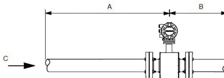
図 3-2 : 上流側および下流側の直管直径
