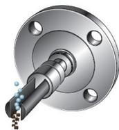
図 2-10: T 字型 (Weldolet 継手) でのメータの設置
