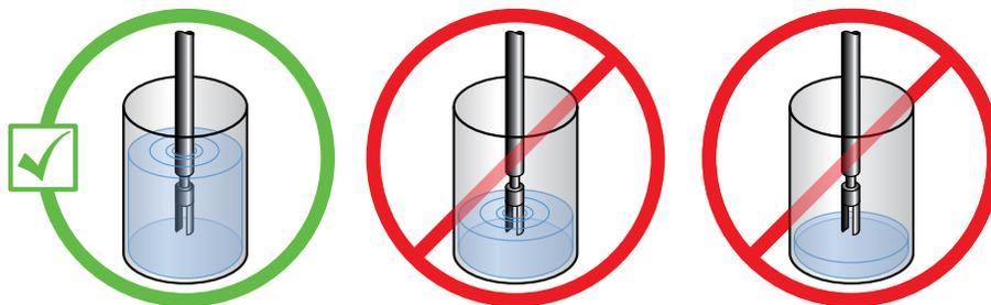
5. メータがタンクの壁や乱流に押し出されないように、メータの位置がタンクの蓋の屈曲に対して余裕があることを確認します。
