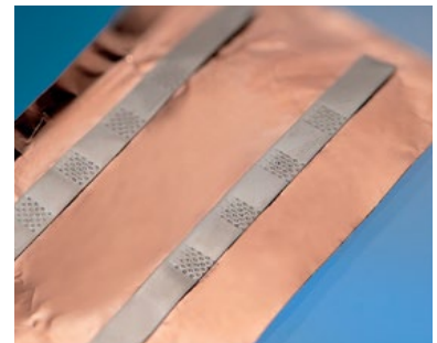
小型バッテリー：Niタブ+ Cuホイル
