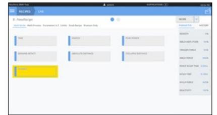
新搭載のダイナミックモードでは、主要なパラメータをリアルタイムで調整する溶着制御ソリューションを提供します。これにより、インサート、ステーキング、スウェーピングなどのアプリケーションに対して、外部センサーやデバイスなしで最適な溶着品質を得ることができます。
