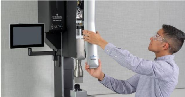
エレクトロメカニカル・アドバンスドアクチュエーションシステムは、Branson GSX-Elite Precisionシリーズと共に使用でき、リアルタイムフィードバックに基づいて直ちに調整可能です。このクローズドループのフィードバックにより、多様なアプリケーションと多彩な部品に対して精度を改善します。
