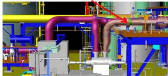
コンディショニング・オリフィス・プレートにより、千代田化工殿では、配管を改造せずに元々設計された位置に計測点を設置できました。
