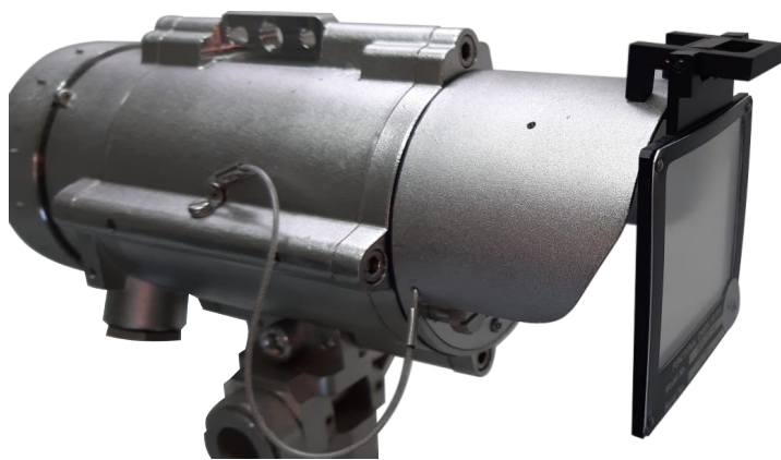
図 2-6: チェックフィルタを取り付けた検知器
