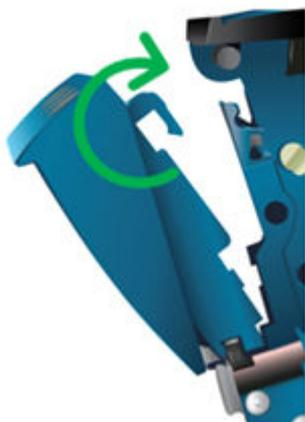
3. 適切に収まるように端子コネクタを押し下げて適切に装着します。
