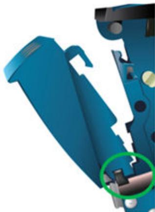
2. プラスチックフックを回して支持プラスチックピースに適切にはめ込みます。
