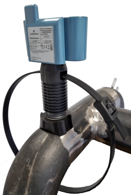
図 3-2: センサーの緩んだストラップ
