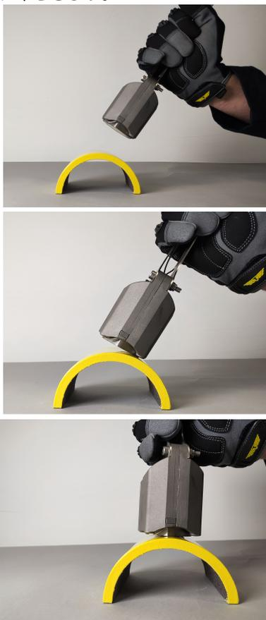
センサーの足元には熱電対もあります。取り付けの際は、熱電対が測定面に接触していることを確認してください。
