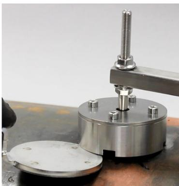
6. 図 5-6 のように、磁気装置を保護キャップに完全にスライドさせます。
