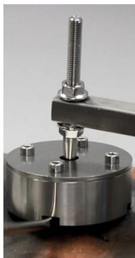
5. 図 5-5 のように、保護キャップを磁気装置の下にスライドさせ、ドライバーを取り外します。
