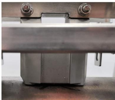
8. [図 4-11](#) のように、センサー固定ボルト 4 本、グリッドロックワッシャー、ナットを磁気固定具に取り付けてください。
