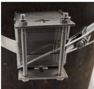
5. むき出しの端を各センサーのストラップホール、センサーヘッドのランヤードホール、ケーブルロックのリターンホールに通します。
