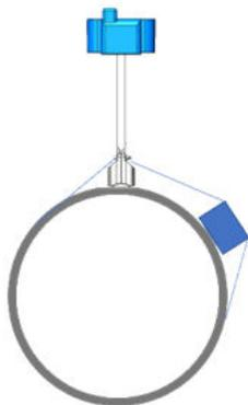
接触面積が大きすぎる、センサーとテンショナーが離れすぎている。
