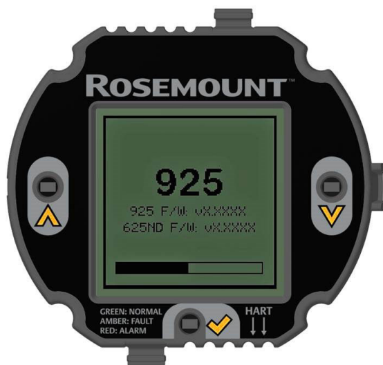
図 2-8 : 起動時のローカル・オペレータ・インターフェース (LOI)
