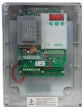
Предназначен для управления до 48 соленоидными клапанами в системе регенерации рукавных фильтров.
