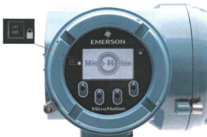
Рисунок 11 - Переключатель защиты от записи электронного преобразователя модели 5700
