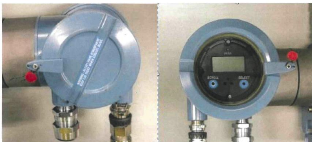
Рисунок 7 - Вариант пломбирования корпуса электронных преобразователей моделей 1700, 2700
