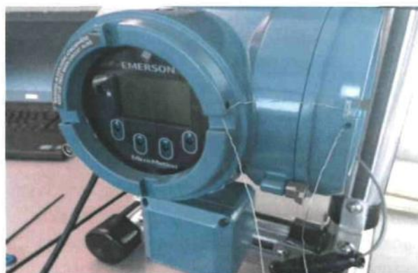
Рисунок 8 - Вариант пломбирования корпуса электронного преобразователя модели 5700
