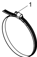
Рис. 6.23: Стальная лента с клеммным замком
