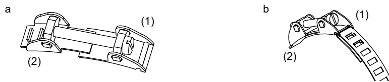
Рис. 6.49: Датчик температуры на трубе
