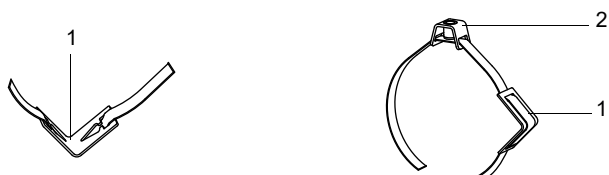
Рис. 6.40: Стальная лента с зажимом и металлической пружиной
