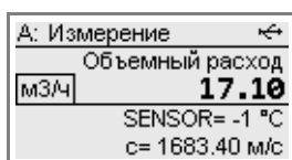
Рис. 9.4: Индикация температуры датчика
