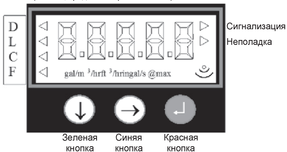
Рис. 4-1. Встроенный дисплей и кнопки
