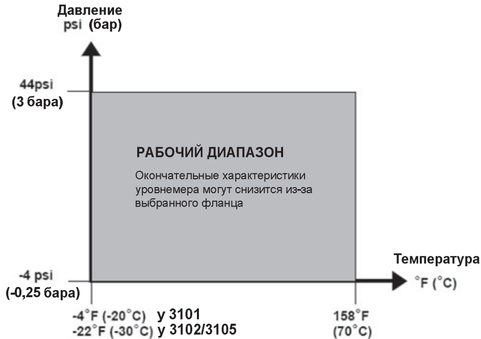
График рабочих температур и давлений для уровнемеров Rosemount серии 3100
