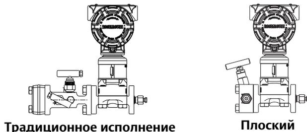
Клапанный блок 306 монтируется непосредственно на преобразователь штуцерного исполнения и поставляется с технологическими соединениями с наружной или внутренней резьбой 1/2 дюйма NPT.
