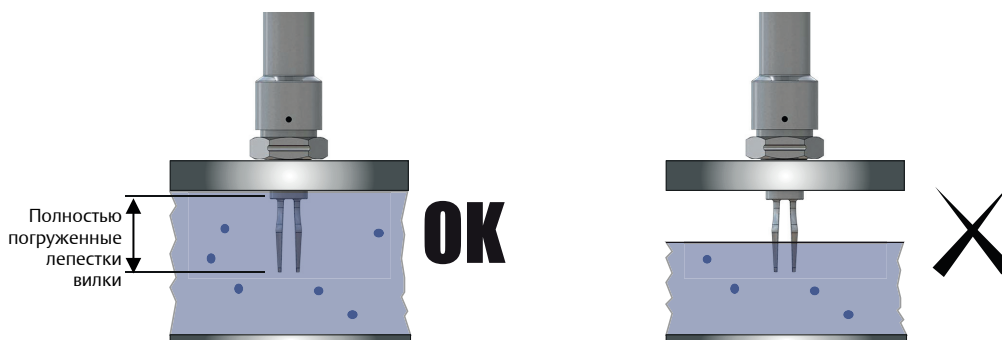
Рисунок 2-4. Полностью погруженные лепестки вилки для функции Калибровки в среде
