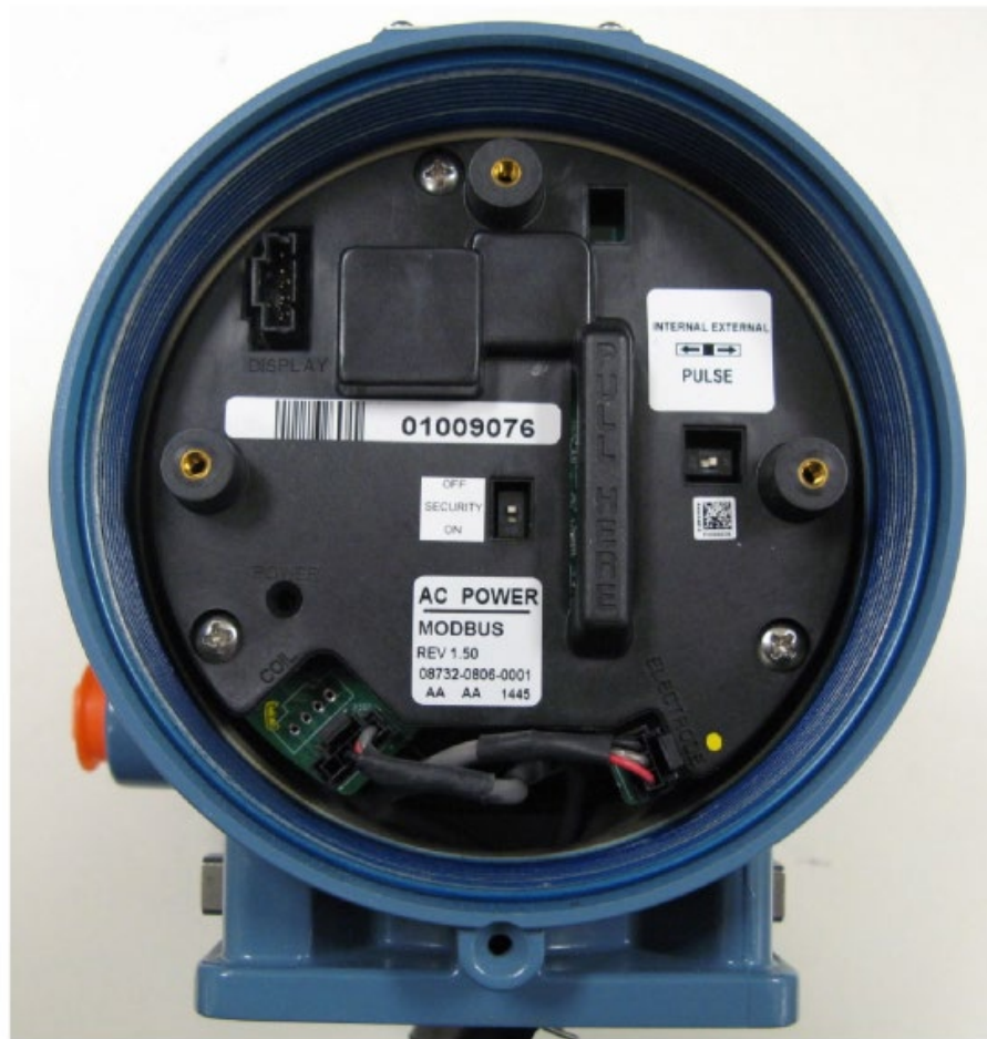
Рис. 6-1. Электронная плата измерительного преобразователя полевого монтажа и аппаратные переключатели
