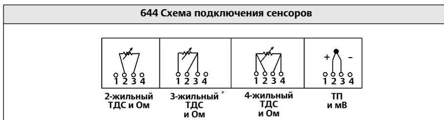
\* Emerson поставляет 4-жильные сенсоры для всех ТДС с одним чувствительным элементом. Данные ТДС в трехжильном исполнении можно использовать, оставив ненужные выводы отсоединенными и изолировав их изолентой.
