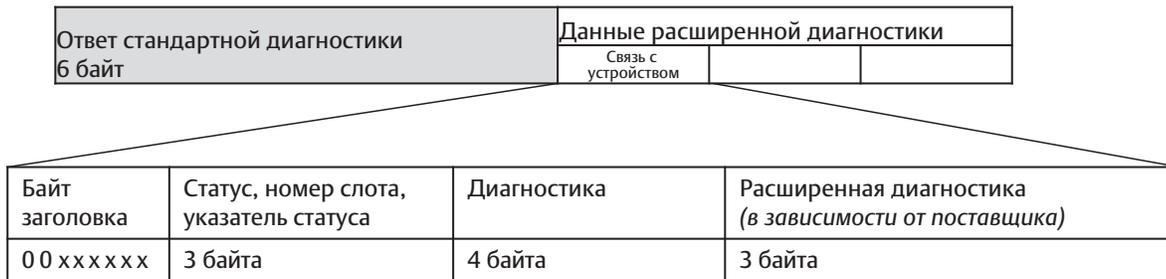
Рисунок 6-2. Идентификация битов диагностики и расширенной диагностики
