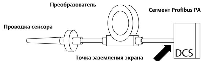
*Соедините вместе экраны, электрически изолированные от преобразователя*
