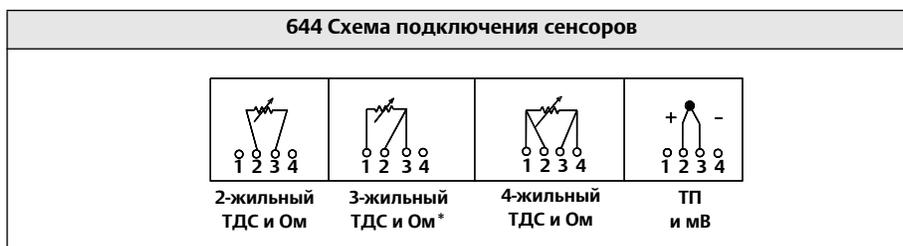
\* Rosemount Inc. поставляет 4-жильные первичные преобразователи для всех ТДС с одним чувствительным элементом. Данные ТДС в трехжильном исполнении можно использовать, оставив ненужные выводы отсоединенными и изолировав их изоляцией.
