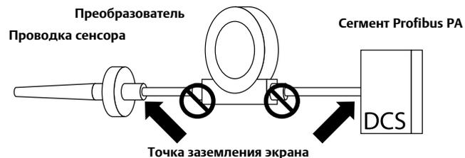
**Заземленные входы термопары**
