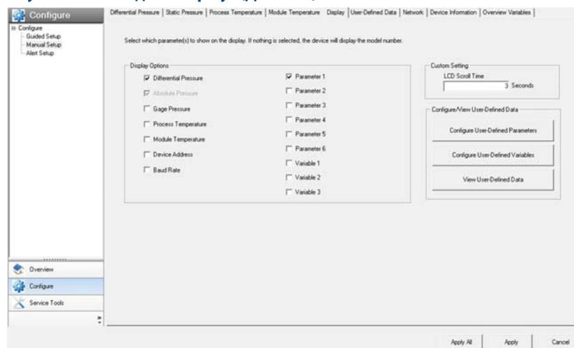
На вкладке *Display* (Дисплей) представлены три типа вариантов отображения (информация, которая появляется на ЖК-дисплее), в том числе переменные устройства, пользовательские параметры и пользовательские переменные.
