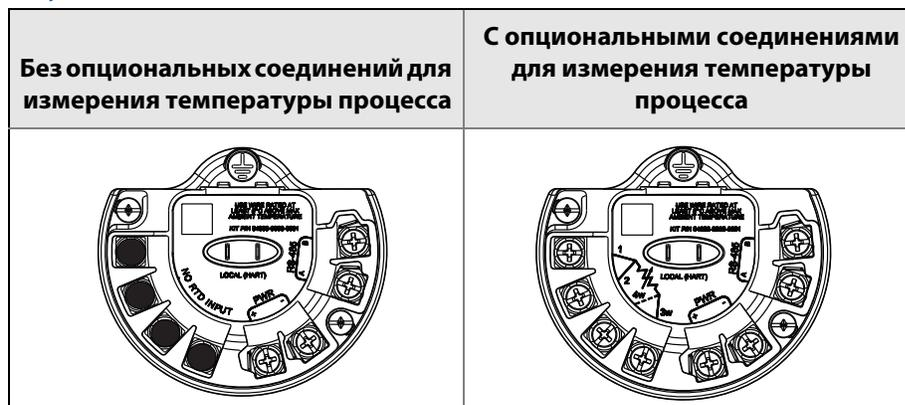
1. Осторожно вставьте клеммный блок в корпус; проследите, чтобы штыревые контакты корпуса Rosemount 4088 правильно вошли в гнезда на клеммном блоке.
