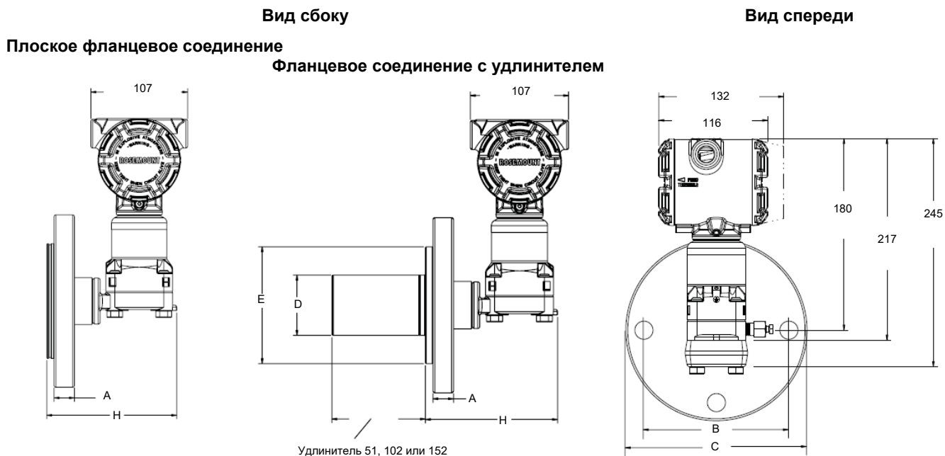
Рис. А-11. Измерительный преобразователь уровня жидкости 3051SAL
