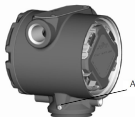
A. \frac{3}{32} -дюймовый установочный винт поворота корпуса
