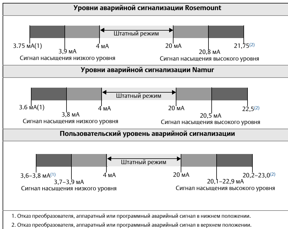
Рис. 7-1. Уровни аварийной сигнализации
