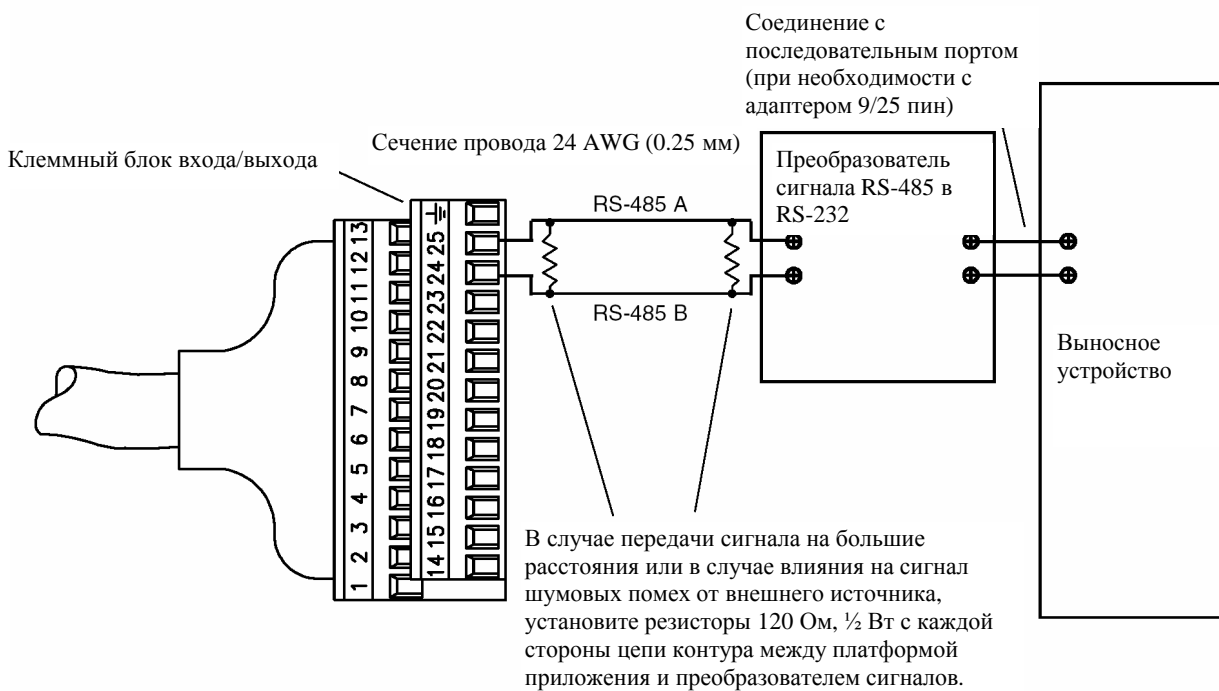
Рисунок 7-3 Модель 3300 или 3500 с преобразователем сигналов RS-485 – кабели входа/выхода
