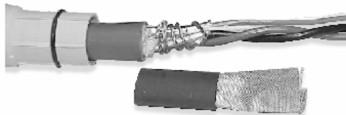
Рисунок 5-8. Обертывание экранированных дренажных проводов
