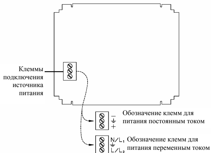
Рисунок 3-5. Клеммы подключения проводов питания на модели 3300 или 3500, монтируемой в стойке
