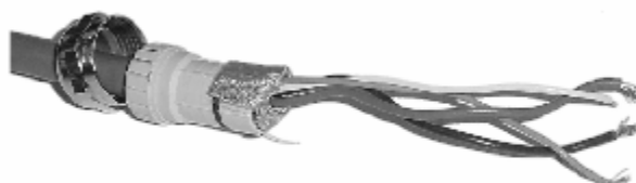
Рисунок 5-10. Свертывание матерчатого экрана
