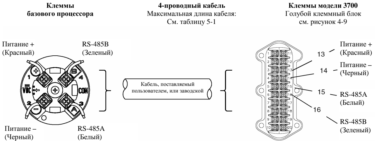
Рисунок 5-4. 4-проводный кабель между базовым процессором и моделью 3700
