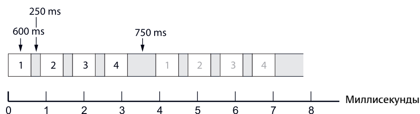
Рисунок 5-3. Пример последовательности светодиодной индикации, соответствующей коду ошибки
