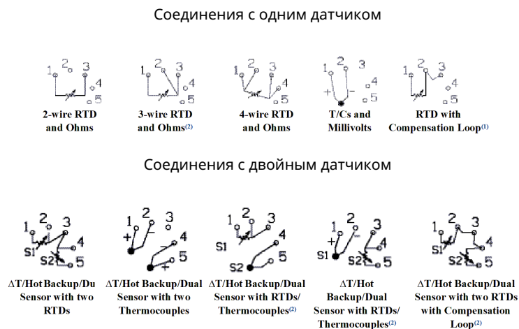
Рисунок 2-13. Схема подключения датчика для FOUNDATION Fieldbus
