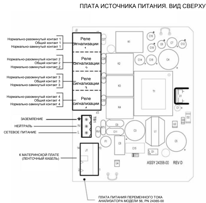
Рис. 3-2. Анализатор модели 56. Разводка питания на плате импульсного источника питания 85-265 В переменного тока PN 24358-00 (код исполнения -03)
