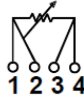
4-х проводная схема соединения с ТС (HART/ Foundation fieldbus)
