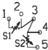
3-х проводная схема соединения с двумя ТС (HART/ Foundation fieldbus)
