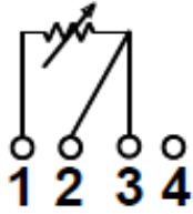
3-х проводная схема соединения с ТС (Foundation fieldbus)
