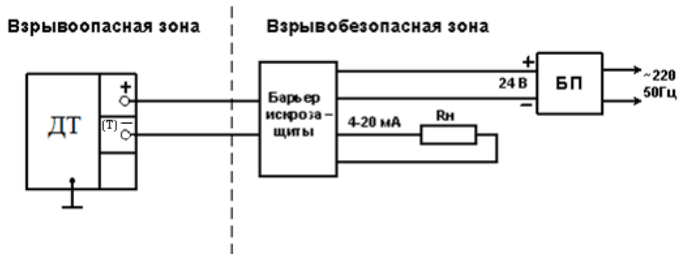
Рисунок Д.1 – Соединение ДТ Rosemount 644, 3144Р исполнения Ex ia с искробезопасным блоком питания БП-Ex
