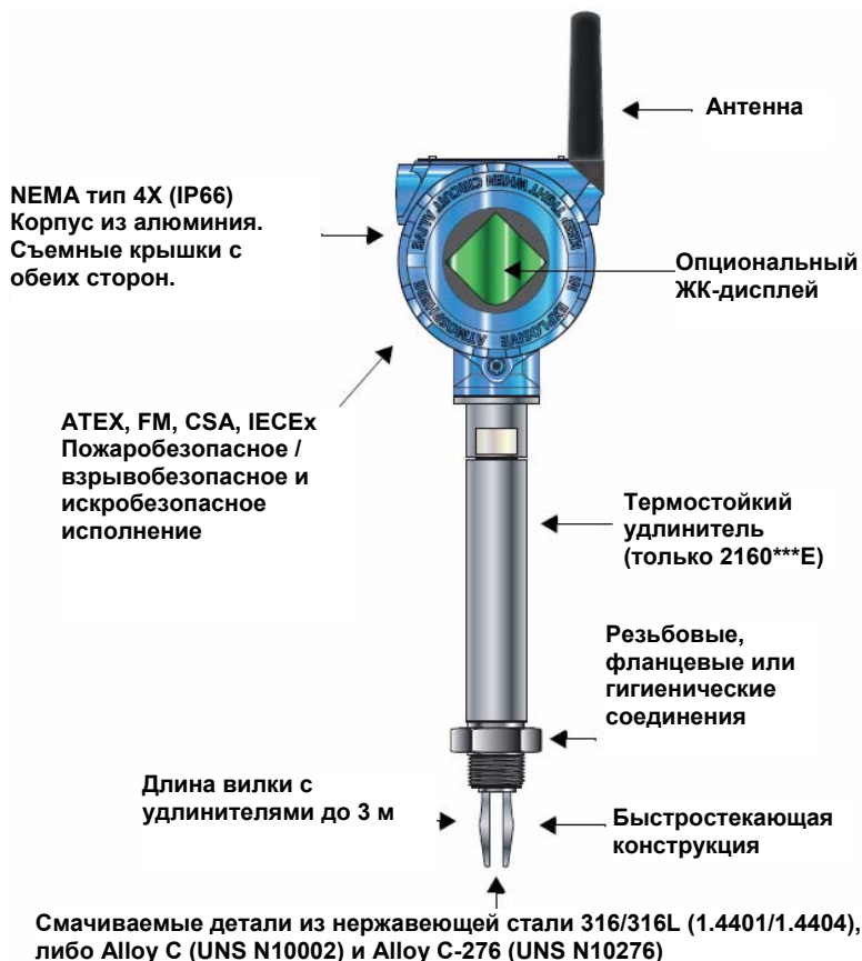
Рисунок 1-1. Функциональные элементы сигнализатора серии 2160
