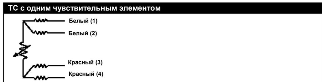
Рисунок 2-3. Конфигурации соединения проводов ТС серии 65, серии 78 для высоких температур и серии 68
