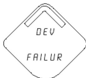
**Device Information – Status** (информация об устройстве – Состояние): существует критическая ошибка, вследствие которой устройство не работает корректно. Проверьте дополнительные экраны состояния для получения более подробной информации.
