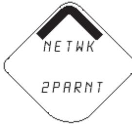
**Diagnostic Button Screen 4.11:** устройство подсоединено к сети, полностью сконфигурировано и имеет несколько исходных элементов
