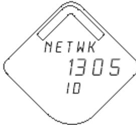
**Diagnostic Button Screen 3** (экран диагностики 3): если устройство имеет надлежащий код соединения, этот идентификатор сообщает пользователю, к какой сети можно подсоединить устройство.
