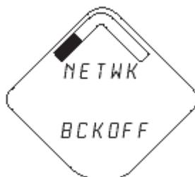
**Diagnostic Button Screen 4.9:** невозможность соединения устройства в связи с отброшенными пакетами, сброс устройства в исходное состояние
