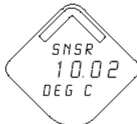
**PV Screen** (Экран первичной переменной): - температура процесса, Ом или мВ в зависимости от того, как сконфигурировано устройство.
