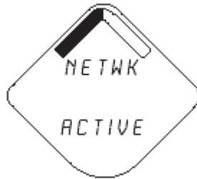
**Diagnostic Button Screen 4.2:** устройство получило команду ACTIVATE (Активировать) из шлюза 1420, но находится в процессе конфигурирования для работы в беспроводной сети
