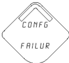
**Diagnostic Button Screen 9.1:** ошибочная конфигурация преобразователя измерительного, которая может повлиять на критическую работу устройства. Проверьте состояние конфигурационных параметров, чтобы определить, какие позиции следует откорректировать.
