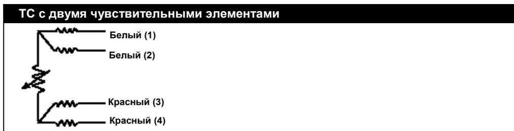
Рисунок 2-4. Конфигурации соединения проводов ТП серии 183
