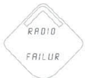
**Diagnostic Button Screen 8:** устройство не может получить информацию из радиоприемника в устройстве – устройство все еще может сохранять функциональность и публиковать данные HART
