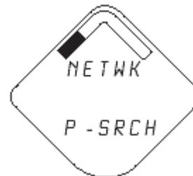
**Diagnostic Button Screen 4.5:** устройство в пассивном поиске
