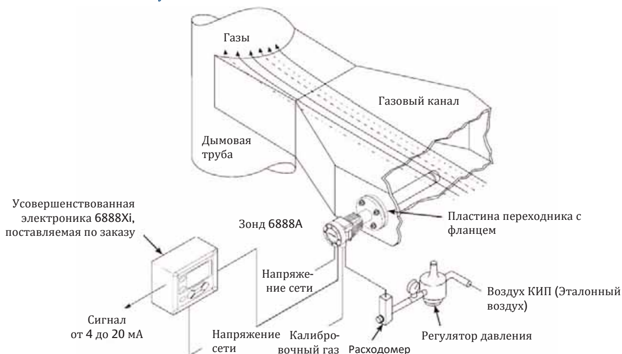
РИС. 2-1. Типовая установка системы
