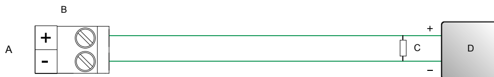
Рисунок 4-4. Подключение частотного выхода (с внутренним питанием)
