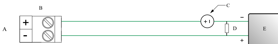
Рисунок 4-4. Подключение дискретного выхода с внешним питанием
