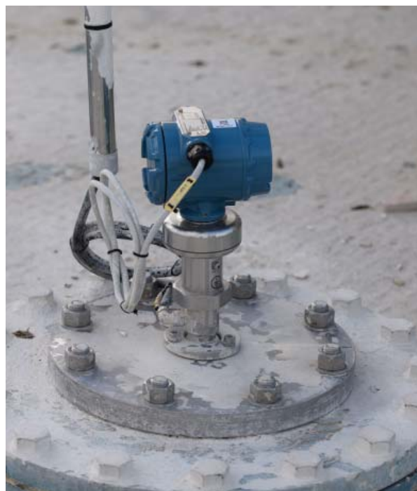
Уровнемер 5408, установленный в бункере с известковым порошком
