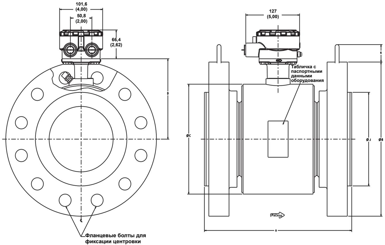
Таблица 38. Расходомеры типоразмера 0,5 – 24 дюйма с плоскими фланцами (мм) – высокого давления (P ≥ ANSI 600#)
