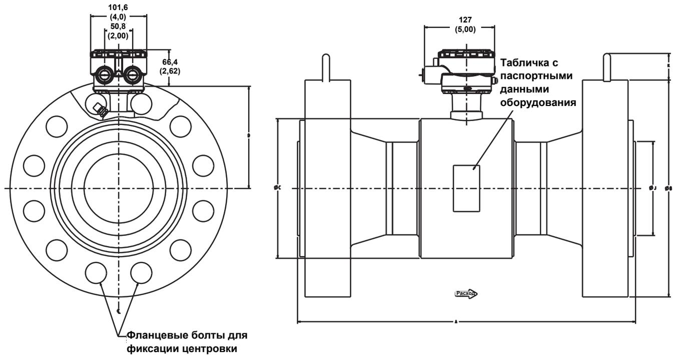
Таблица 39. Расходомеры типоразмера 1 – 24 дюйма с воротниковыми фланцами (мм)
