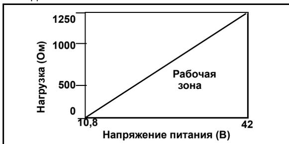
$$R_{\text{макс.}} = 41,7 (V_{\text{ps}} - 10,8)$$
