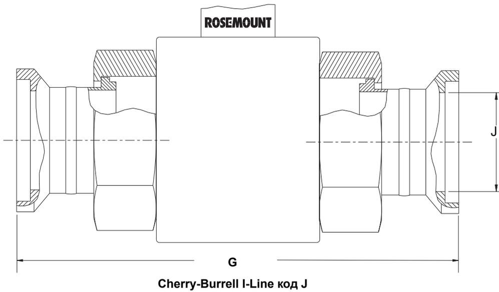
Рис. 25. Rosemount 8714D, калибровочный стандарт
