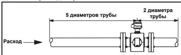
Возможна установка на ограниченных прямых участках длиной от 0 до 5 диаметров трубы. На ограниченных прямых участках трубопровода характеристики могут измениться. Регистрируемые значения расхода стабильно будут иметь высокую степень воспроизводимости.
