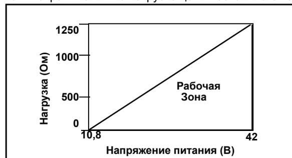
$$R_{\text{макс.}} = 41,7 (V_{\text{ps}} - 10,8)$$
