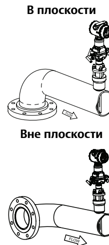
Рис. 1. Anubar в плоскости и вне плоскости
