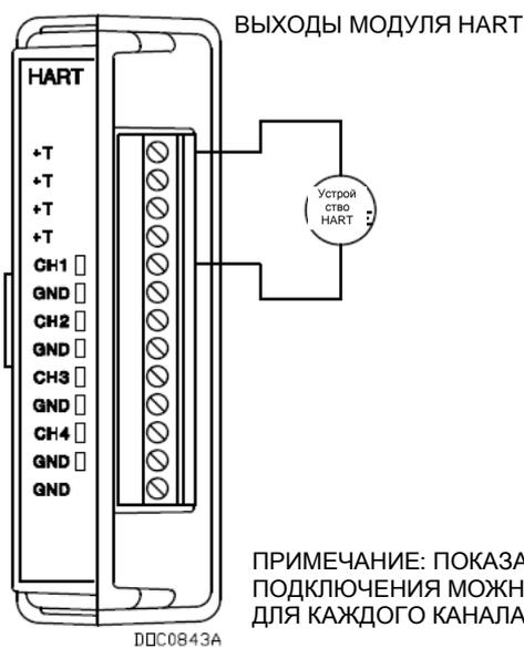
ПРИМЕЧАНИЕ: ПОКАЗАННУЮ СХЕМУ ПОДКЛЮЧЕНИЯ МОЖНО ПОВТОРИТЬ ДЛЯ КАЖДОГО КАНАЛА
