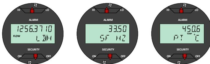
Дополнительный 11-значный двухстрочный встроенный ЖК-дисплей можно сконфигурировать на переключение между выбранными вариантами отображения, например расхода, сумматора, токового выхода (mA), температуры (MTA/MCA) и давления (MPA/MCA). Диагностика и состояния отказа (при наличии) также отображаются на дисплее для локального поиска и устранения неисправностей.
