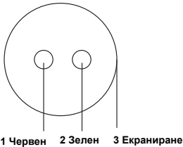
Фигура 17. Електрическа схема за комбиниран бобинен и сигнален кабел
